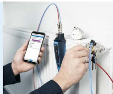
**Application** Pour mesurer et régler le débit volumique directement sur le corps de robinet, par ex. avec le CAPBs® Set équilibrage corps de robinets comme appareil de mesure pour l'équilibrage hydraulique. Convient aux petites, moyennes et grandes quantités d'eau. Pour l'installation dans des installations de chauffage bitube. Le type est conforme à la norme, c'est pourquoi l'installation dans des bâtiments existants est possible sans modification de la tuyauterie de raccordement.
