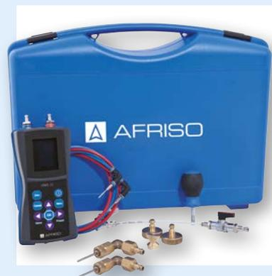
**Anwendung** Zur Messung von Differenzdruck und Einregulierung des Durchflusses in Heizungs- und Kälteanlagen im Rahmen des hydraulischen Abgleichs. Zu verwenden in Kombination mit VarioQ-Thermostatventilen, VarioQ-Kombiblöcken oder marktüblichen Strangarmaturen mit Messfunktion.
